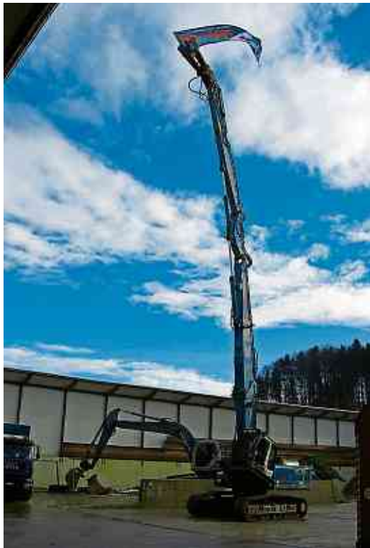
Abbruchbagger Longfront 45 Tonnen 2007
