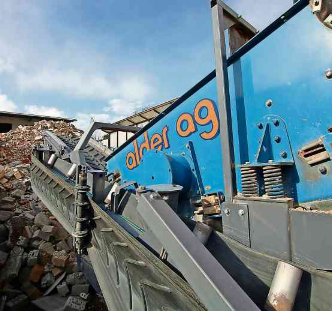
Für den Transport und die Verkleinerung von Bauabfällen werden spezielle Maschinen verwendet.
