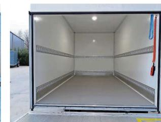
Als Basis für den Aufbau dient immer ein Chassis mit Kabine. Wir beraten Sie gerne zu den vielen Modell- und ausbauvarianten. Der Zugang zu Kofferaufbauten ist meistens hinten in Kombination mit einer Hebebühne. Auf Wunsch können selbstverständlich auch Klappen und Türen auf den Seiten verbaut werden. Bei Kofferaufbauten empfiehlt sich eine Rückfahrkamera.
