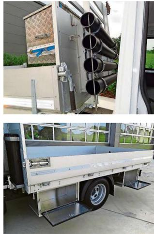
Ein durchdachtes Detail von vielen: Die Halterungen für die Triopan-Faltsignale sind am Kipperaufbau direkt hinter dem Fahrerhaus angebracht und von beiden Seiten erreichbar. So sind sie immer sofort griffbereit, wenn das Fahrzeug angehalten und auf einer Baustelle abgesichert werden muss.
