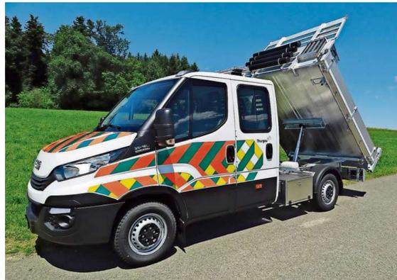
Für den Kanton Thurgau durften wir diesen IVECO mit Doppelkabine und Kipper umsetzen. Alle An- und Aufbauten sind aus Aluminium oder rostfreiem Stahl. Das garantiert Langlebigkeit im täglichen Einsatz.
