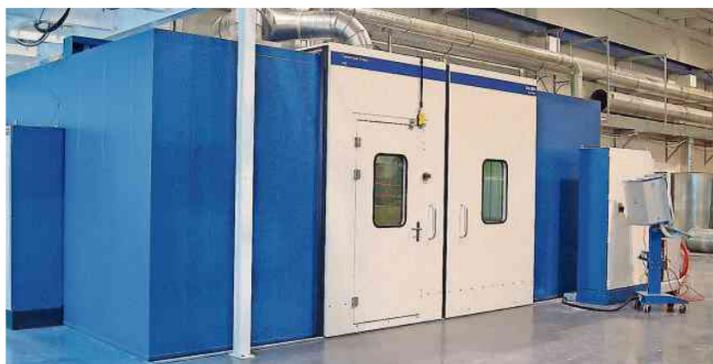
Dank des Fachwissens der Elkuch Eisenring AG kann dieser Lärm auf etwa 70 dB reduziert werden. Dies gelingt durch Wand- und Deckenelemente aus Blech mit eingebetteter Steinwolle. Zudem werden Zu- und Abluftschalldämpfer eingesetzt, welche die beim Prozess entstehende Wärme und Staubpartikel über ein Filtersystem nach aussen leiten.
