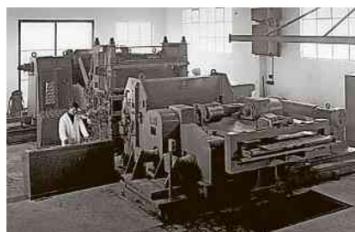
1966 Eine Querteilanlage zum Schneiden von Stahlcoils (Blechrollen) wird angeschafft.
