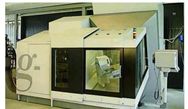
Die Elkuch Eisenring AG entwickelt und fertigt solche Gehäuse für renommierte Werkzeugmaschinenhersteller. Diese Verkleidungen sind nicht
